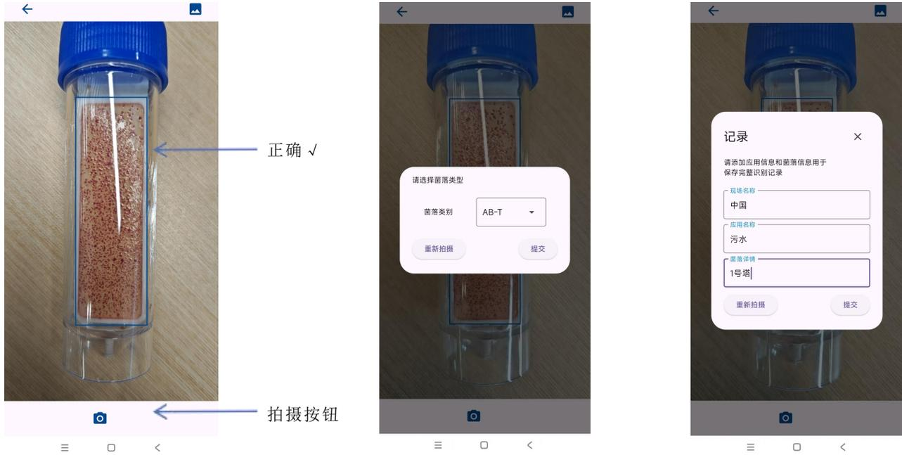
左侧显示计算结果，右侧显示相应的菌落浓度，可手动选择调整（手动选择时，可扫描外包装上的二维码，获取说明书中的菌落密度对照表进行判断），最终结果以右侧为准。查看要保存的图像，点击“确认”保存图像。
