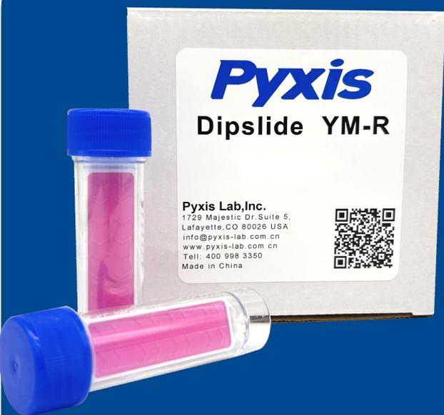
测菌片（Dipslide）最早是用于解决运输介质的过程中样品发生各种物理、化学及微生物的变化应运而生。因其便于携带，能够保持样品的各项性能，同时兼具了性价比高的优点而广泛运用于工业水系统、冷却水、生产及填料用水等各类流体的检测。
