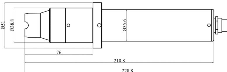
ST-765SS-Series Oxidizer + pH Sensor
